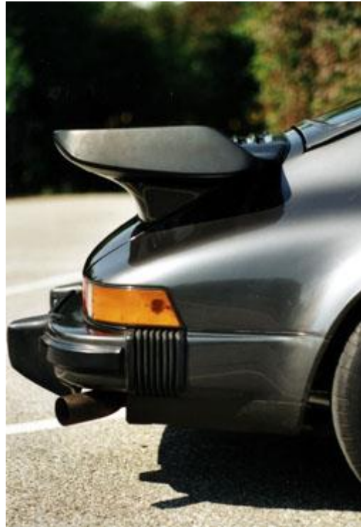
Um die Ansaug-Anlage unterzubringen, verwendete Lenz den Heckspoiler eines 3,3 Turbo. Foto: mn
