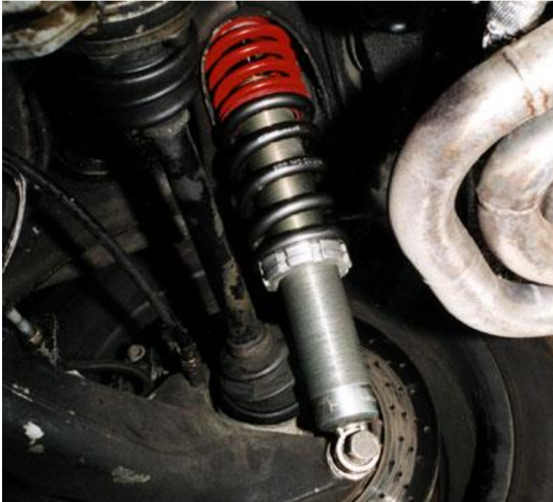
Ein Schraubenfederfahrwerk - hier die Hinterachse - gehört zu den tiefgreifenden Modifikationen am Fahrwerk.
