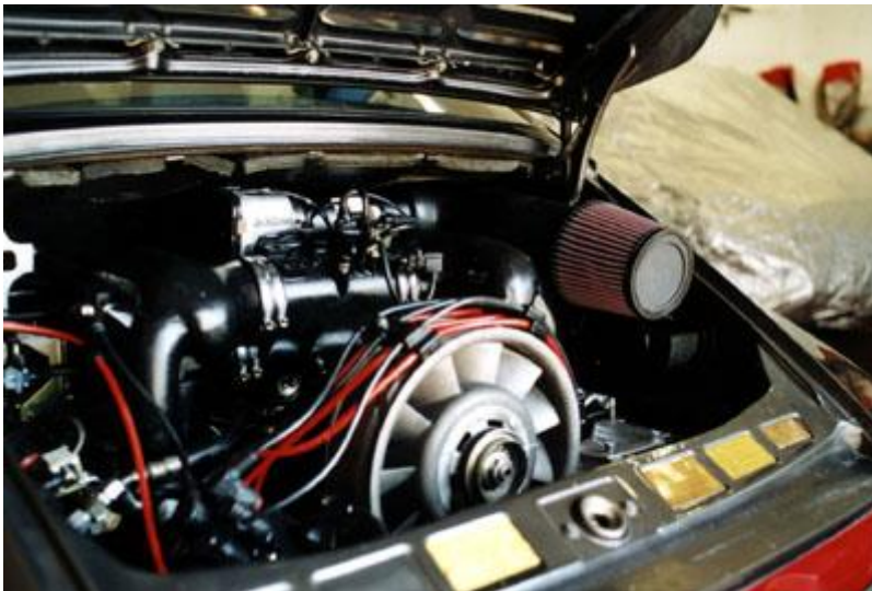
Schon auf den ersten Blick fällt der veränderte Ansaugtrakt beim Ultra-Motor auf.
